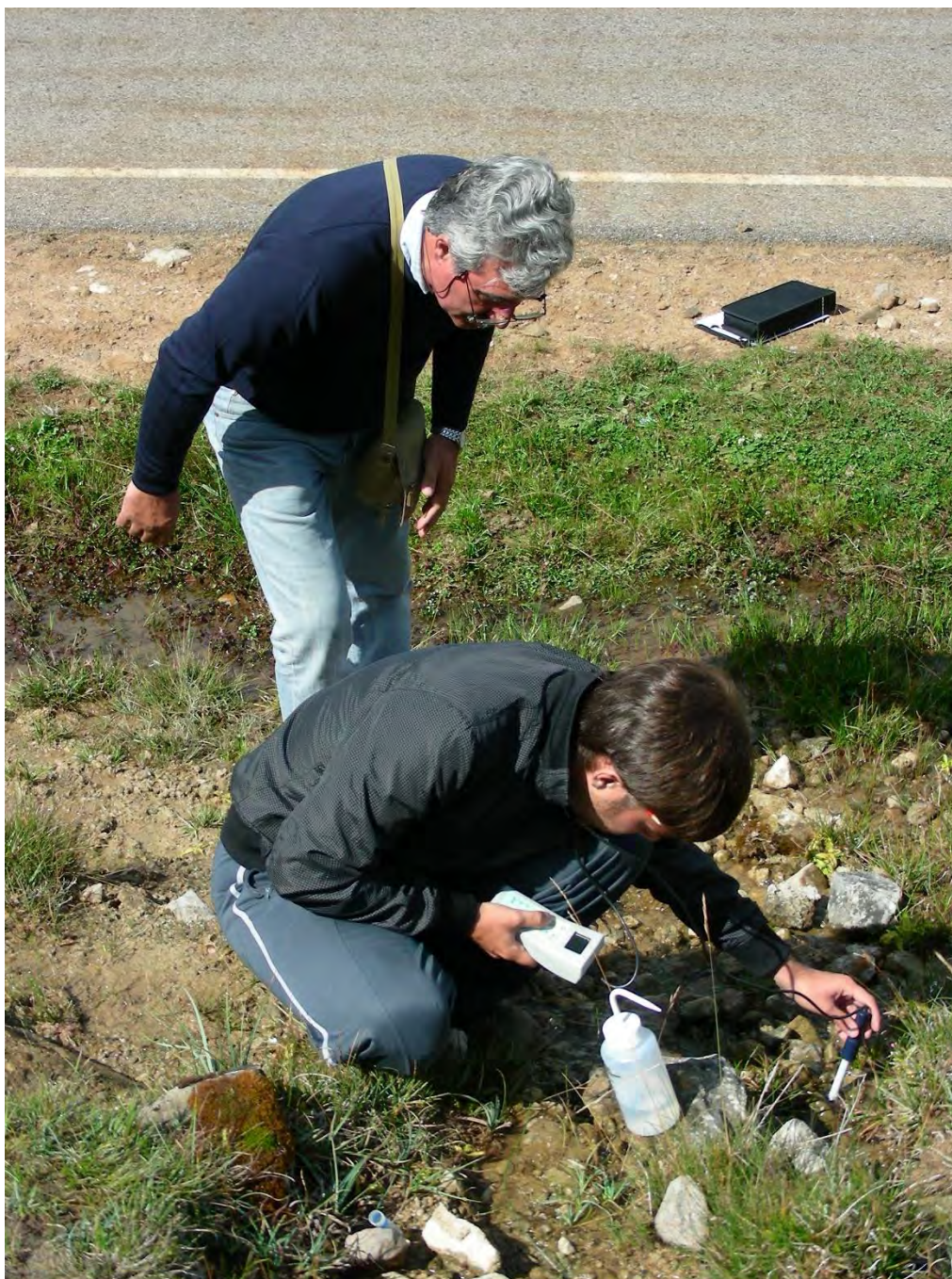
Medida de análisis de pH directamente en el terreno.
